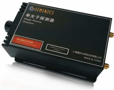
**星秒光电**光子计数模块SPD500是基于Si-APD的超灵敏光电探测器。探测波段覆盖400-1060nm。可工作在线性模式和盖革模式。盖革模式下增益超过60dB。SPD500特有的高性能主动抑制电路，可以实现连续的单光子探测，并且可加载任意宽度和周期的探测门。该电路实现了大于20 dB的雪崩抑制，从而将SPD500的性能发挥到最佳状态。在650nm波段的探测效率超过65%，暗计数小于1000cps，死时间小于50 ns。
